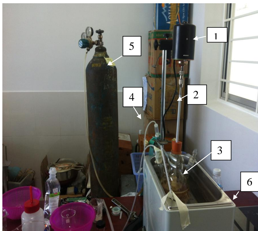
Hình 6. NaOH 2M được đưa nhanh vào hỗn hợp dung dịch muối sắt; 1- Động cơ; 2- Đũa khuấy; 3- Bình ba cổ; 4- ống dẫn khí Nitơ; 5- Bình chứa khí Nitơ; 6- Bếp gia nhiệt;
